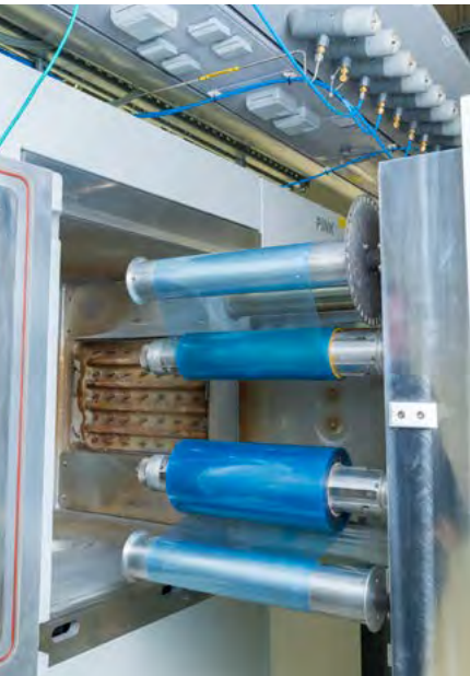
Kontinuierliche Ausrüstung mit einer PFAS-freien Antihafschicht im Rolle-zu-Rolle-Verfahren
