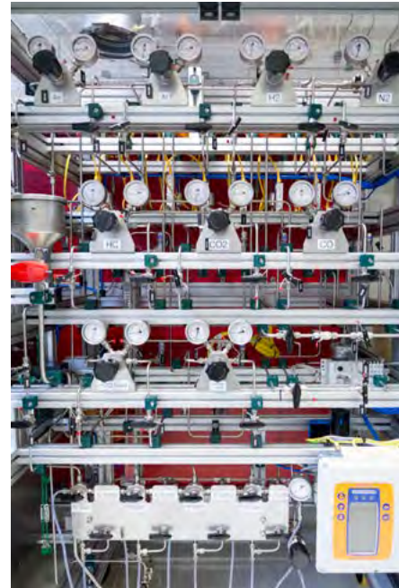
Vielseitige Anlage zur Entwicklung von Prozessen zur Umsetzung gasförmiger Edukte, z. B. von CO 2 und Wasserstoff
